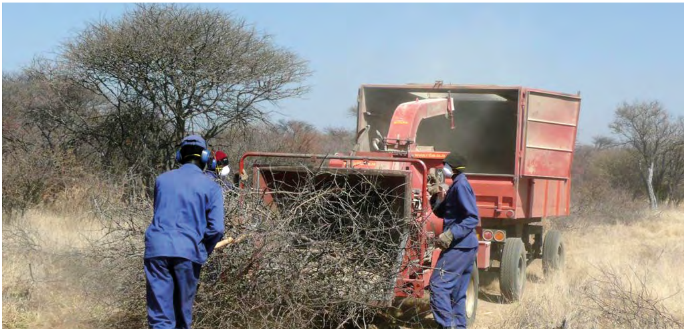
Collecte manuelle de broussailles à l'aide de haches, et transformation mécanique en copeaux de bois dans la région d'Otjozondjupa en Namibie (Fonds de Conservation de Guépards).
