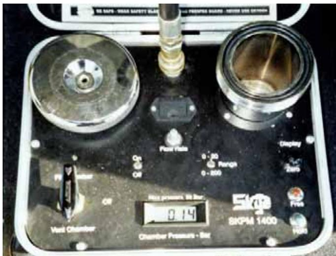
Abbildung 4.2: Die Scholander-Druckbombe im Detail. (O. r.: Druckkammer, o. Mitte: Druckluftzufuhr o. l.: Hingelegter Druckkammerverschluss mit Öffnung für den einzuspannenden Pflanzenzweig. U. l.: Druckzufuhr-Regler, u. Mitte: Druckanzeige, u. r.: Druck-Unterbruchtaste (grün)
