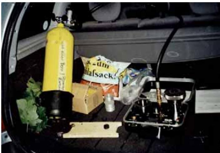
Abbildung 4.3: Wasserpotenzialmessungen in frühen Morgenstunden mit der Scholander-Druckbombe
