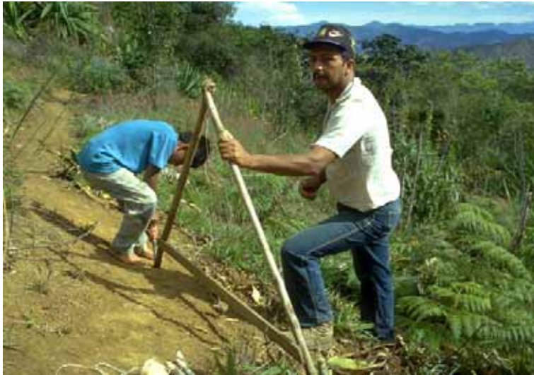
Foto 22: Vermessen der Höhenkurven mit dem A-Rahmen
